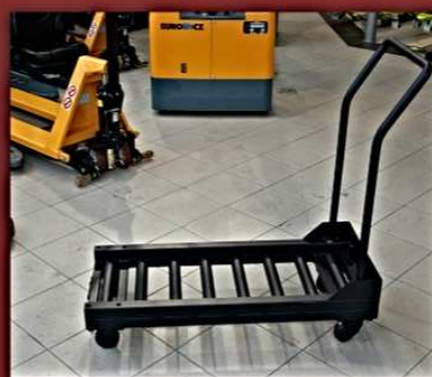
vozíky na výměnu baterií
